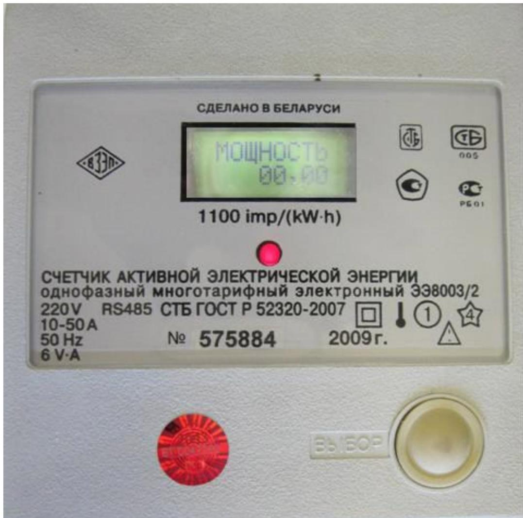
Индикация текущего значения потребляемой активной мощности нагрузкой (пример  $P=00.00$  кВт, при отсутствии нагрузки).
