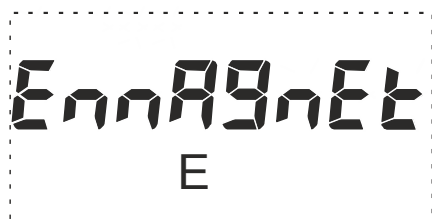
Рисунок 2.10 Информация, выводимая на ЖКИ при ВЧ электромагнитном воздействии на счетчик
