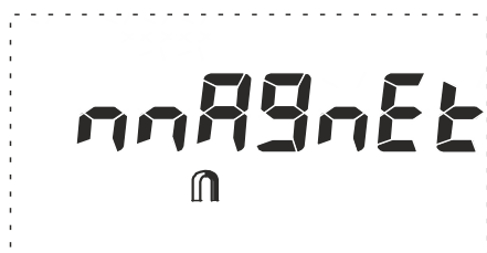
Рисунок 2.9 Информация, выводимая на ЖКИ при магнитном воздействии на счетчик
